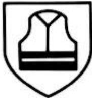
Exigences de performance sont indiquées pour la couleur et la rétro réflexion ainsi que pour les surfaces minimales et le positionnement des matériaux utilisés.
